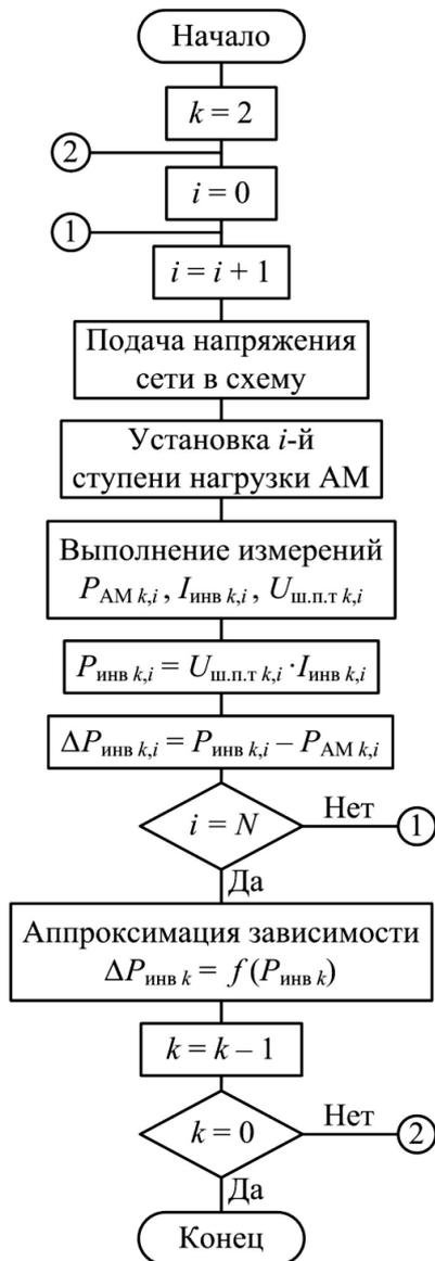
Рис. 4. Алгоритм первого этапа определения мощности (предварительный этап перед испытаниями асинхронных двигателей)
