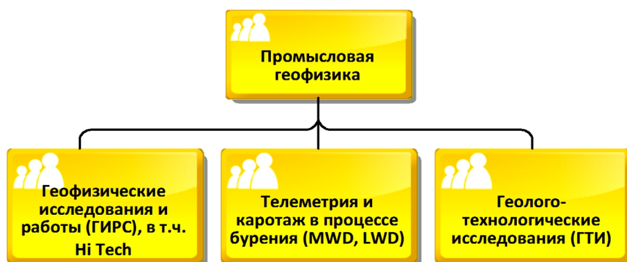
Рис. 1. Классификация геофизических исследований и работ в скважинах
