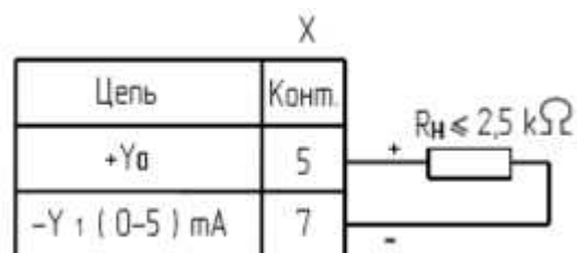
Рисунок 4 - Схемы подключения нагрузки РЗД-22 для выходного сигнала (0-5) мА
