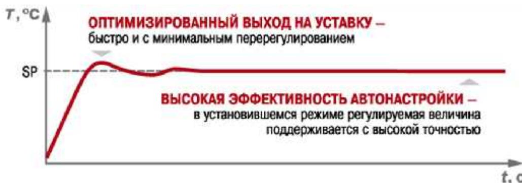
Рисунок 3 – График переходного процесса после подачи возмущения
