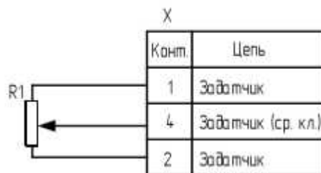
Рисунок 1 – Схема электрическая принципиальная задатчика РЗД-12
