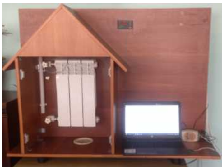
Рисунок 6 – Лабораторный стенд «Системы контроля и регулирования систем отопления»
