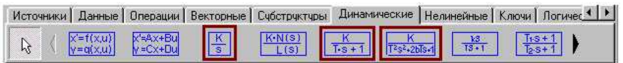
Рисунок 3 - На вкладке Динамические блоки помещены образцы моделей элементов линейных систем. Для начала, обратим внимание на интегратор, апериодическое и колебательное звенья
