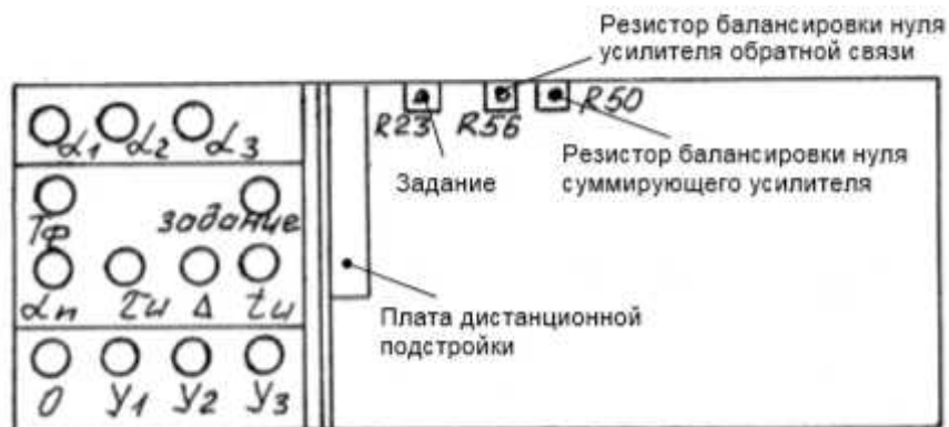
Рисунок 4 - Органы настройки регулятора РП4-У
