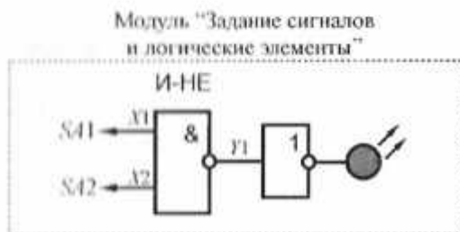
Рис. 2.7. Схема электрическая соединений лабораторного модуля для изучения работы логического элемента И-НЕ
