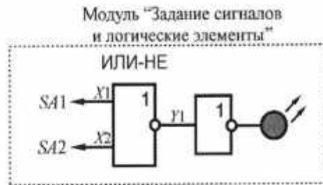
Рис. 2.8. Схема электрическая соединений лабораторного модуля для изучения работы логического элемента ИЛИ-НЕ
