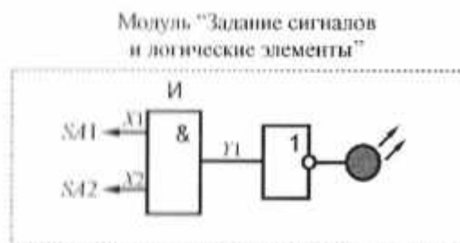
Рис. 2.4. Схема электрическая соединений лабораторного модуля для изучения работы логического элемента И
