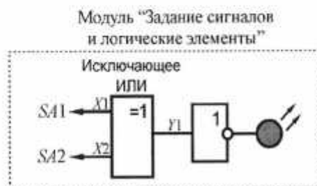
Рис. 2.9. Схема электрическая соединений лабораторного модуля для изучения работы логического элемента исключающее ИЛИ
