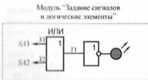
Рис. 2.5. Схема электрическая соединений лабораторного модуля для изучения работы логического элемента ИЛИ
