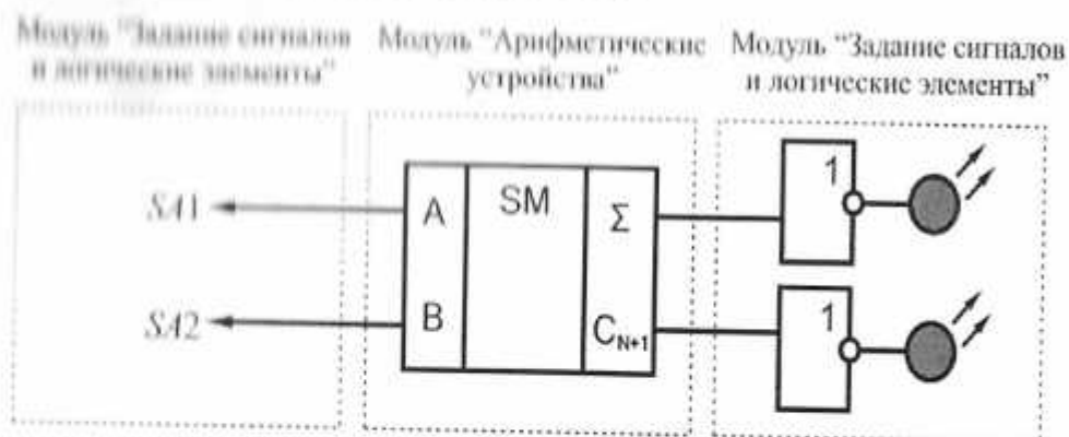
Рис. 13.6. Схема электрическая соединений лабораторных модулей для изучения работы полусумматора
