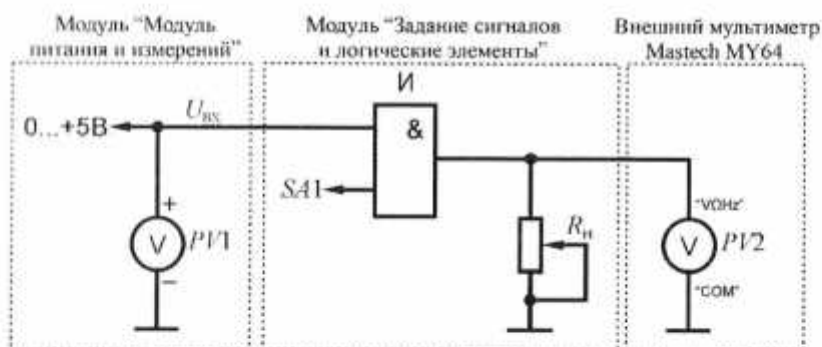
Рис. 2.1. Схема электрическая соединений лабораторных модулей для изучения передаточной характеристики логического элемента И
