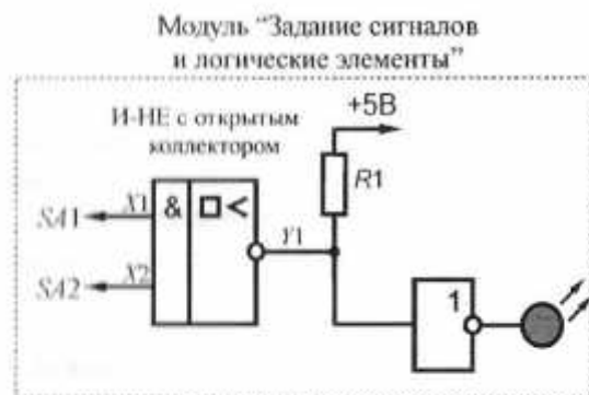
Рис. 2.10. Схема электрическая соединений лабораторного модуля для изучения работы логического элемента И-НЕ с открытым коллектором
