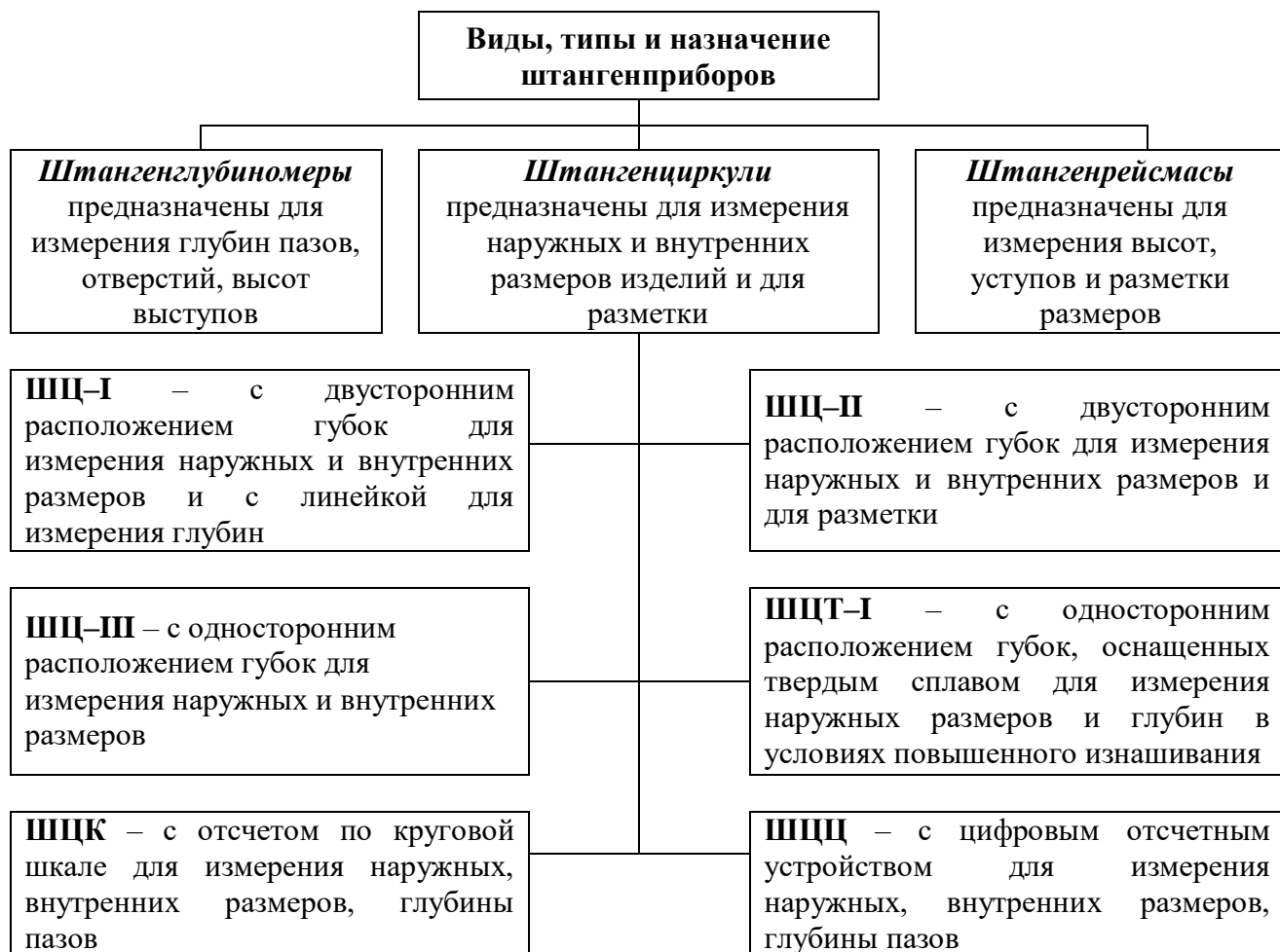
Рисунок 1 – Виды, типы и назначение штангенприборов
