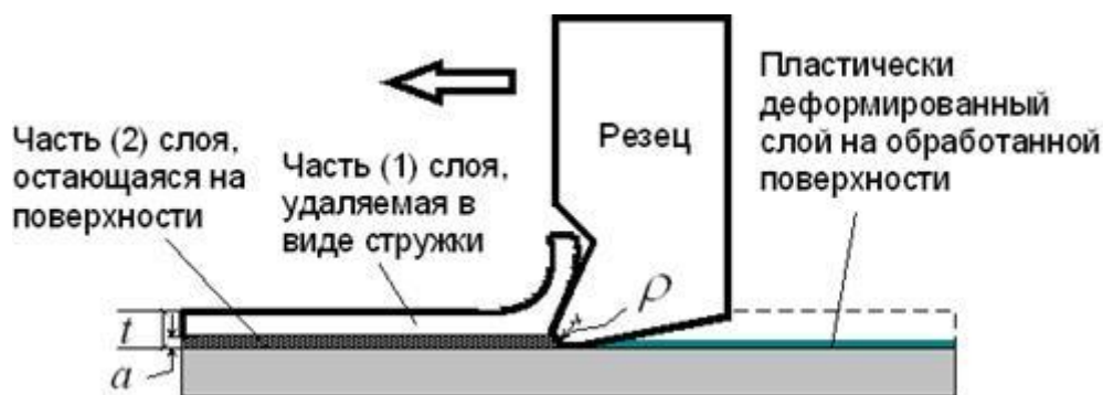
Рис.3.4. Пластическая деформация металла при резании
