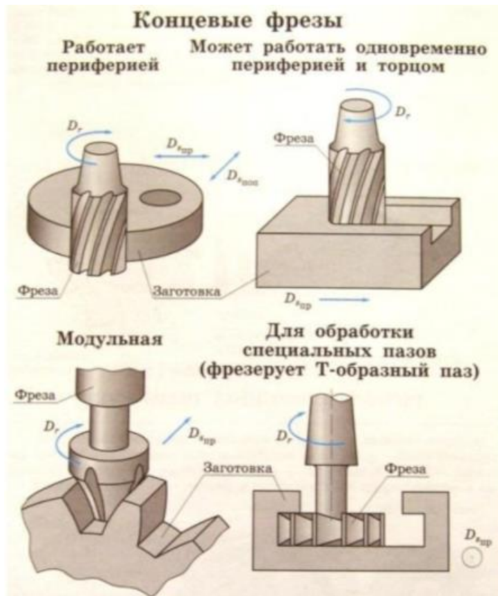
Рис.9.3. Концевые фрезы
