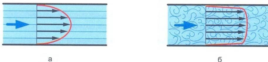
Рисунок 1 – Эпюры скоростей при ламинарном (а) и турбулентном (б) режимах течения жидкости
