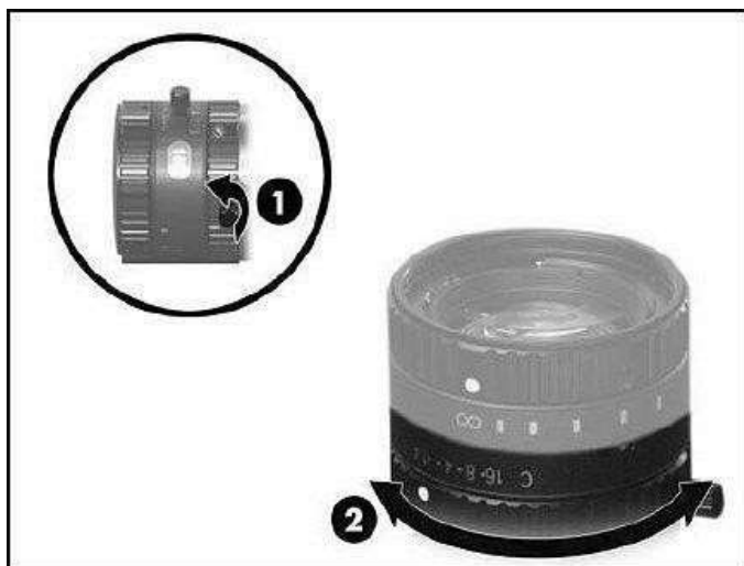
Рис. : Настройка апертуры с последующим затягиванием винтов
