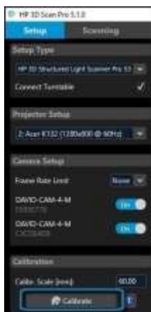
Рис. : Калибровка сканера
