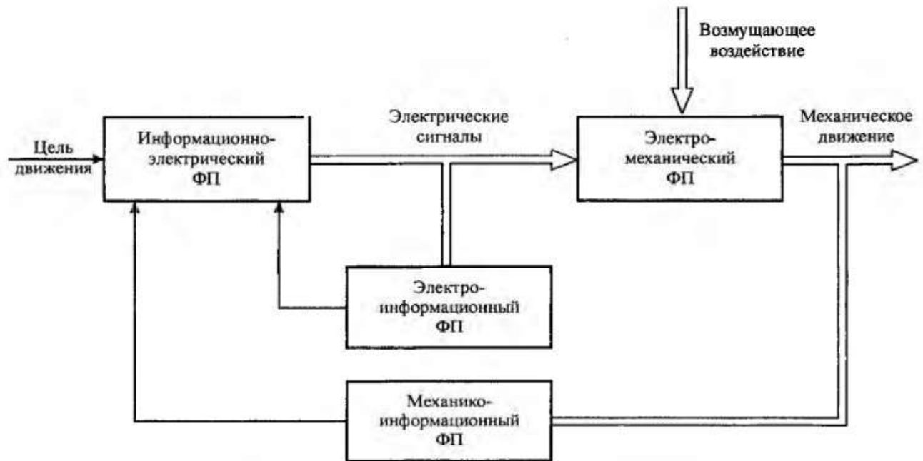
Рисунок 2 – Информационные и энергетические потоки в мехатронной системе.
