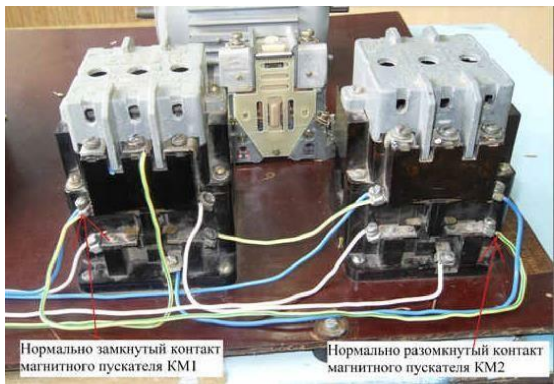
Рисунок 75 – Сборка перемычки между блок-контактами магнитного пускателя схеме обратного вращения двигателя на стенде 12. Закрывать крышку кнопочного поста (рисунок 76).
