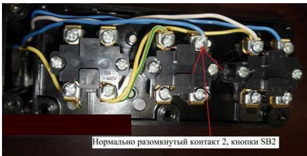
Рисунок 64 – Сборка соединения пусковой кнопки обратного вращения двигателя с блок-контактом магнитного пускателя на стенде
