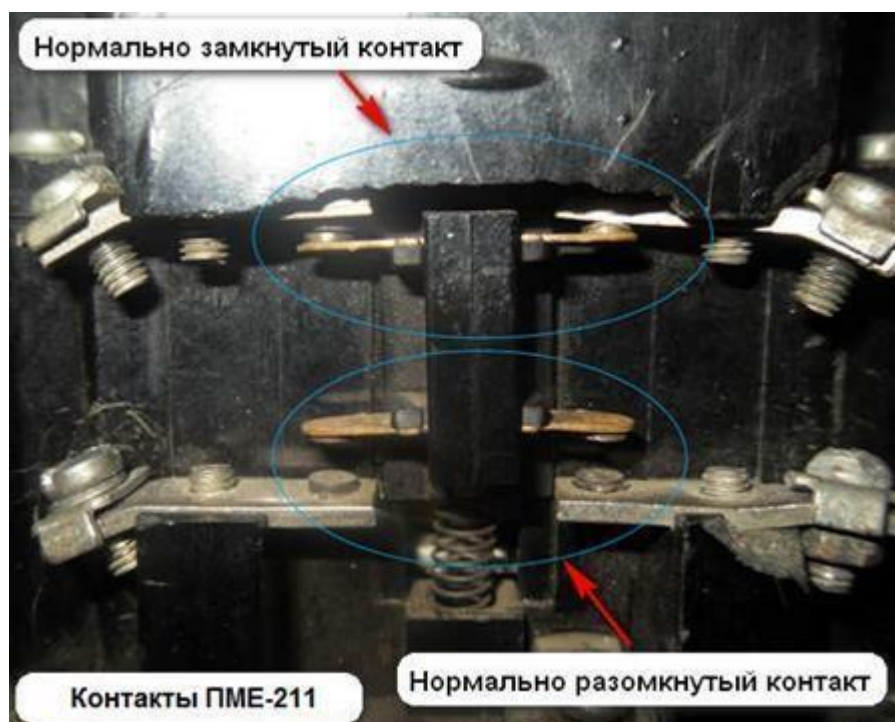
Рисунок 7 – Виды контактов магнитного пускателя
