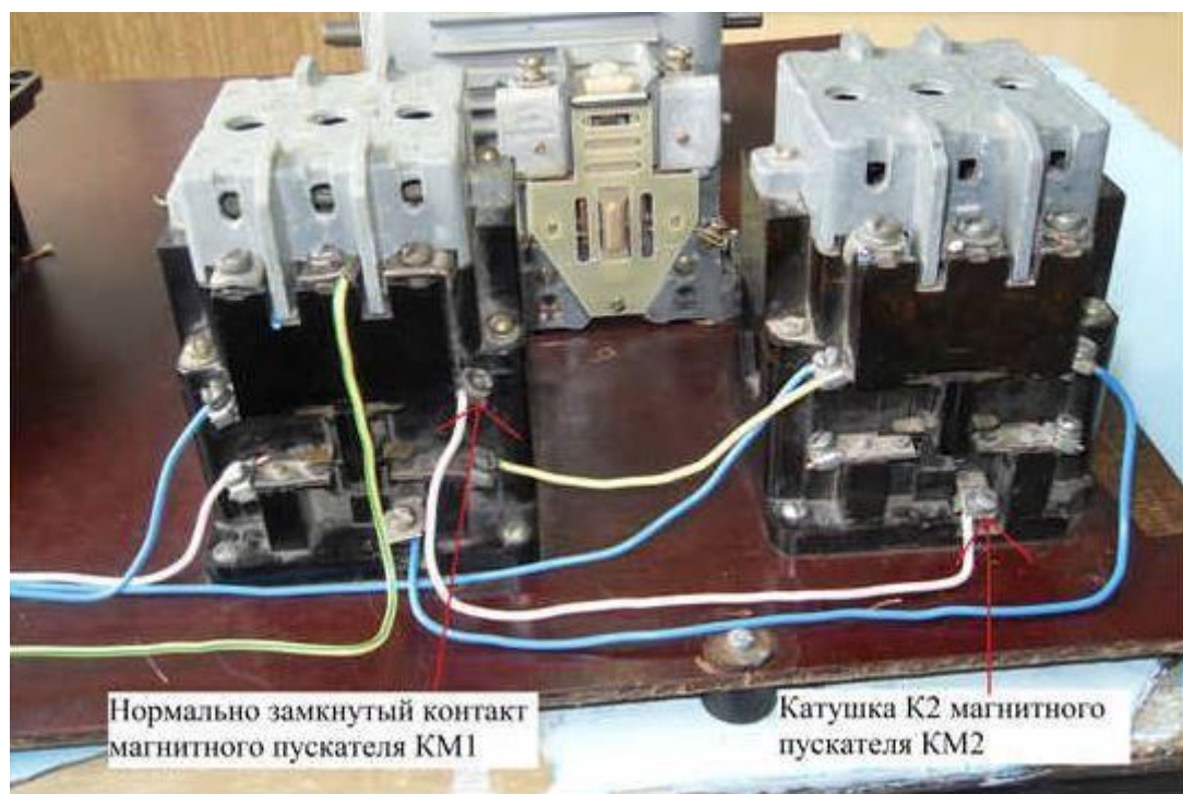
Рисунок 68 – Сборка соединения блок-контакта магнитного пускателя с катушкой магнитного пускателя на стенде
