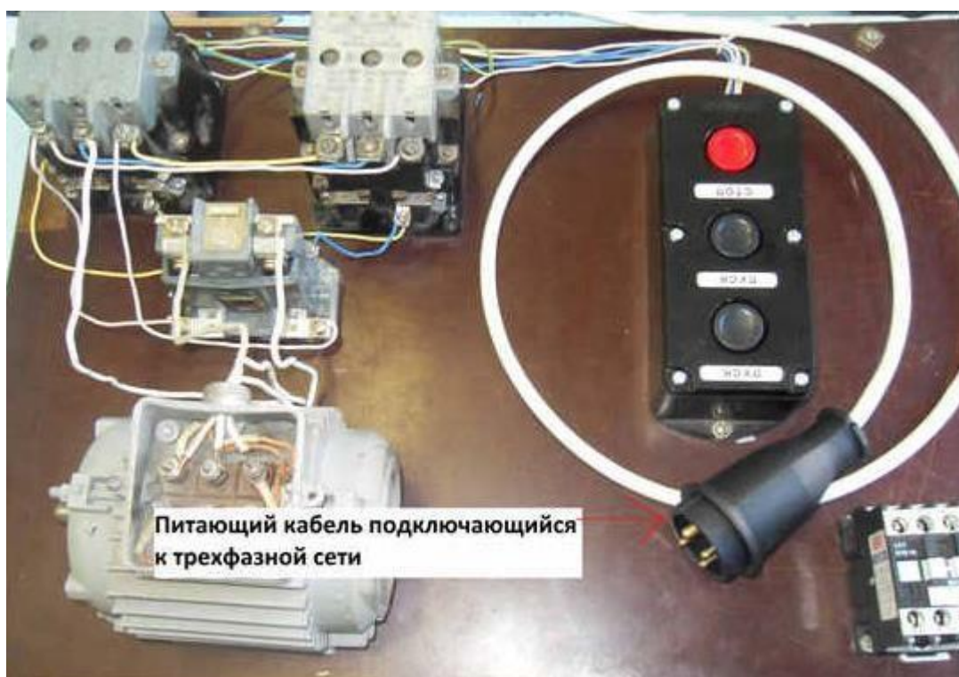
Рисунок 90 – Подключение трехфазной вилки к магнитному пускателью на фазы «А», «В», «С» сети на стенде
