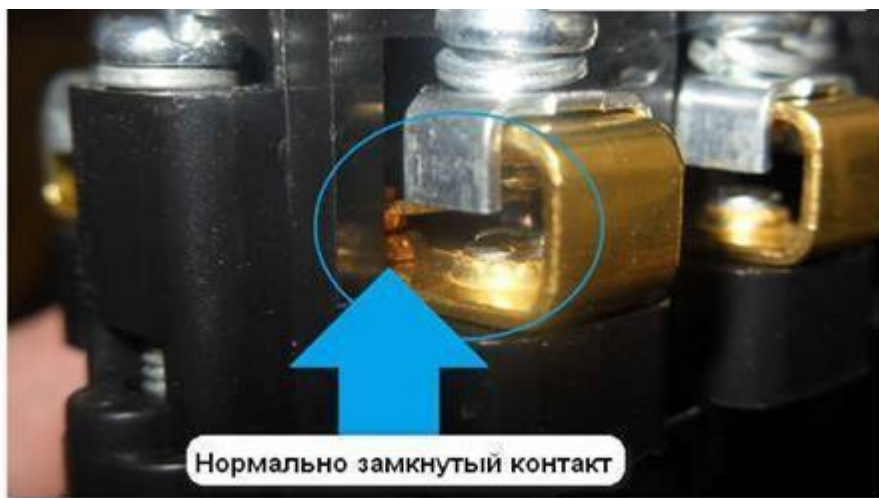
Рисунок 9 – Виды контактов кнопок
