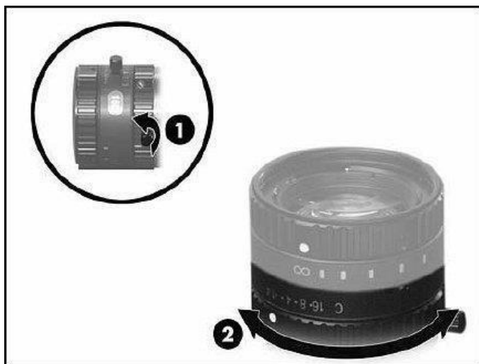
Рис. : Настройка апертуры с последующим затягиванием винтов
