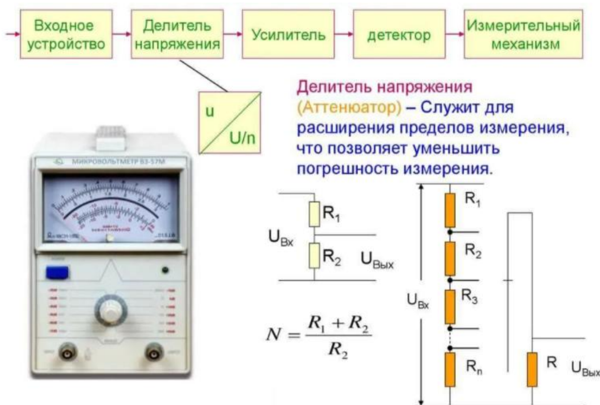
Рисунок 1 - Делитель напряжения
