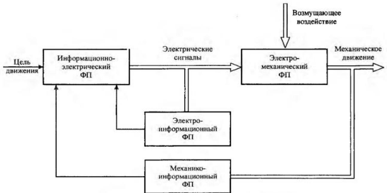
Рисунок 2 – Информационные и энергетические потоки в мехатронной системе.
