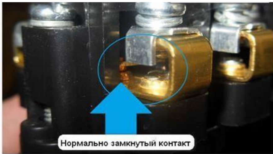
Рисунок 9 – Виды контактов кнопок
