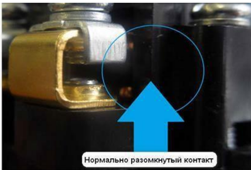
Рисунок 10 – Виды контактов кнопок
