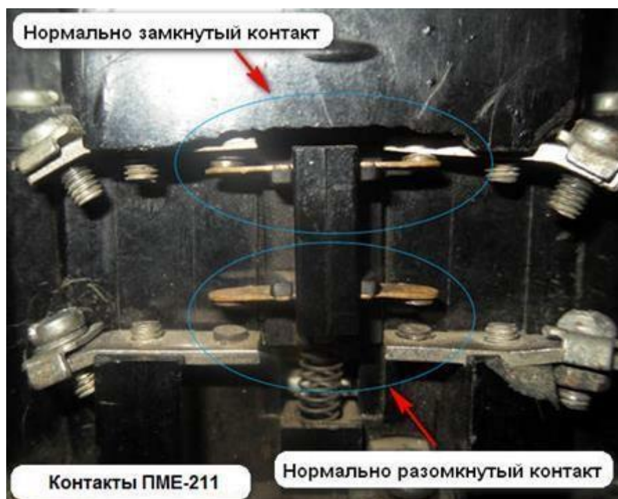
Рисунок 7 – Виды контактов магнитного пускателя
