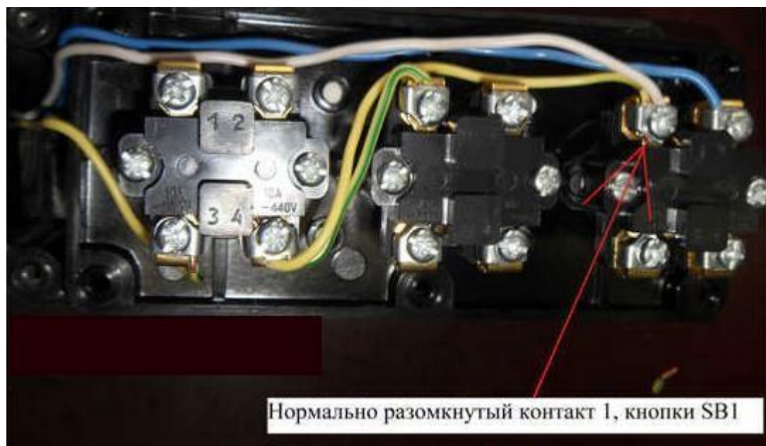
Рисунок 30 – Нормально разомкнутый контакт кнопки прямого вращения двигателя
