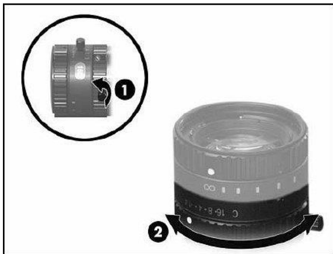
Рис. : Настройка апертуры с последующим затягиванием винтов
