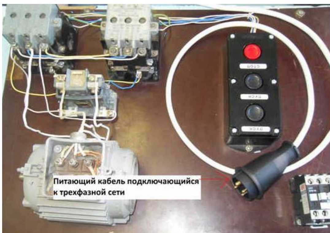
Рисунок 90 – Подключение трехфазной вилки к магнитному пускателю на фазы «А», «В», «С» сети на стенде
