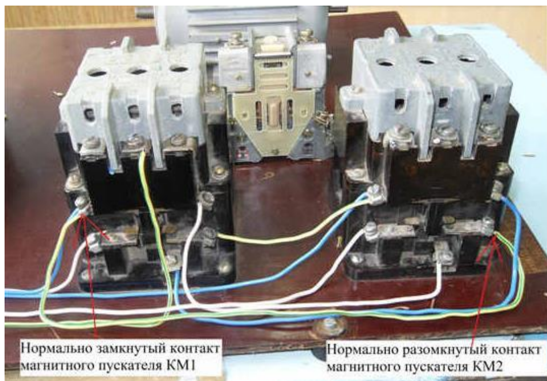
Рисунок 75 – Сборка перемычки между блок-контактами магнитного пускателя схеме обратного вращения двигателя на стенде
