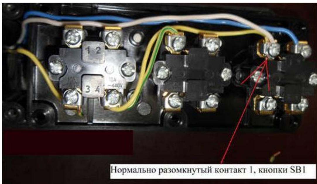
Рисунок 30 – Нормально разомкнутый контакт кнопки прямого вращения двигателя
