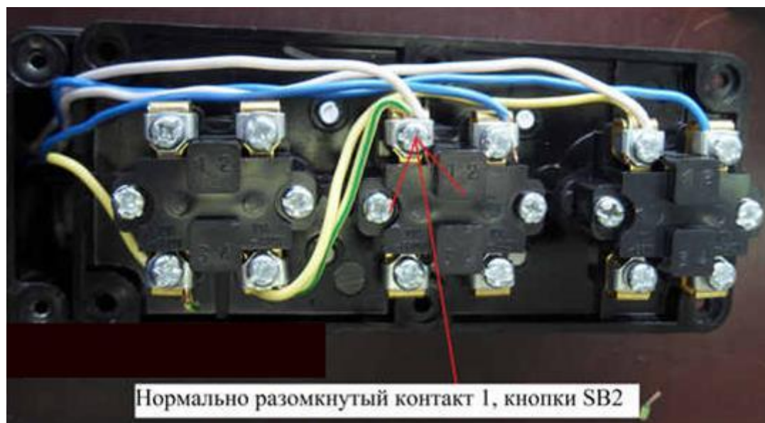
Рисунок 71 – Шунтирование пусковой кнопки обратного вращения блок-контактом магнитного пускателя на стенде
