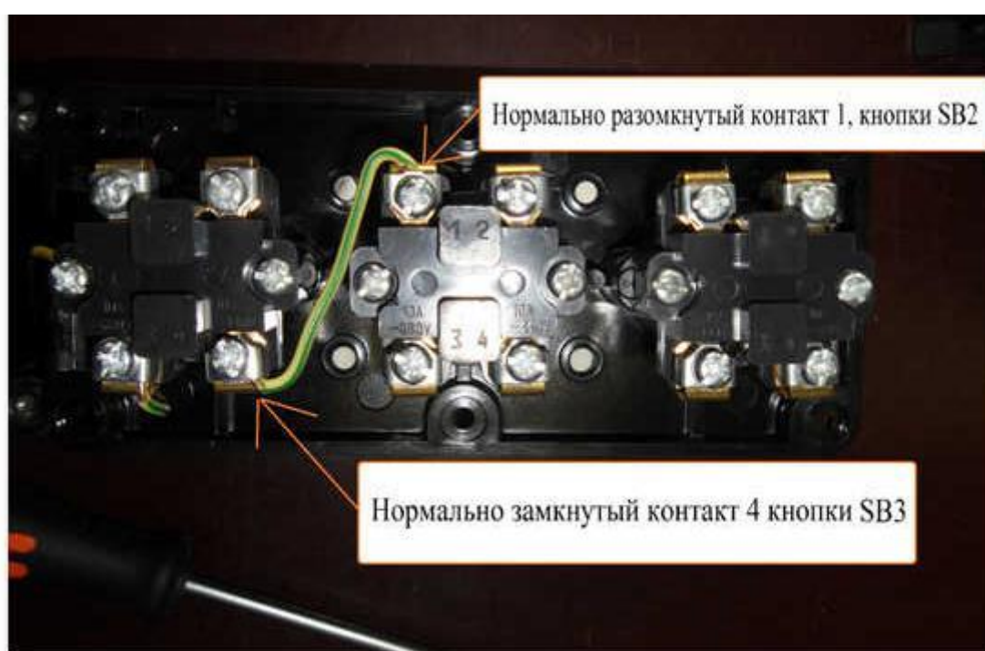
Рисунок 16 – Сборка перемычки между кнопками на стенде
