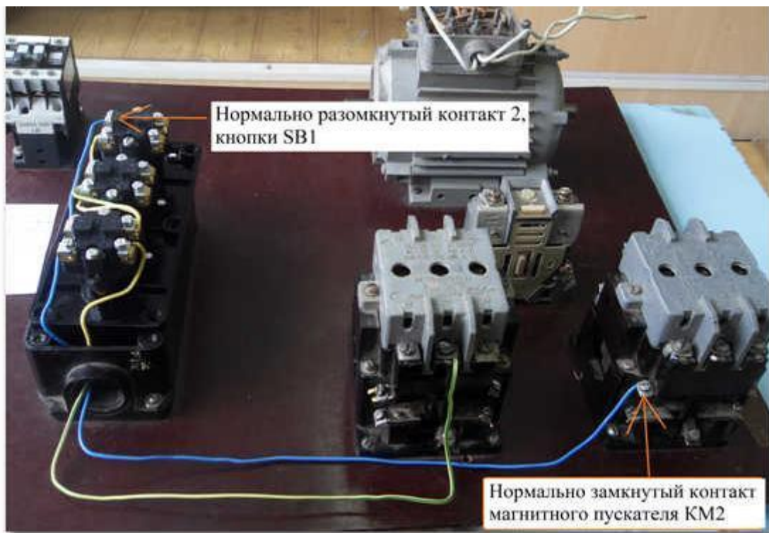
Рисунок 22 – Сборка соединения пусковой кнопки прямого вращения двигателя с блок-контактом магнитного пускателя на стенде
