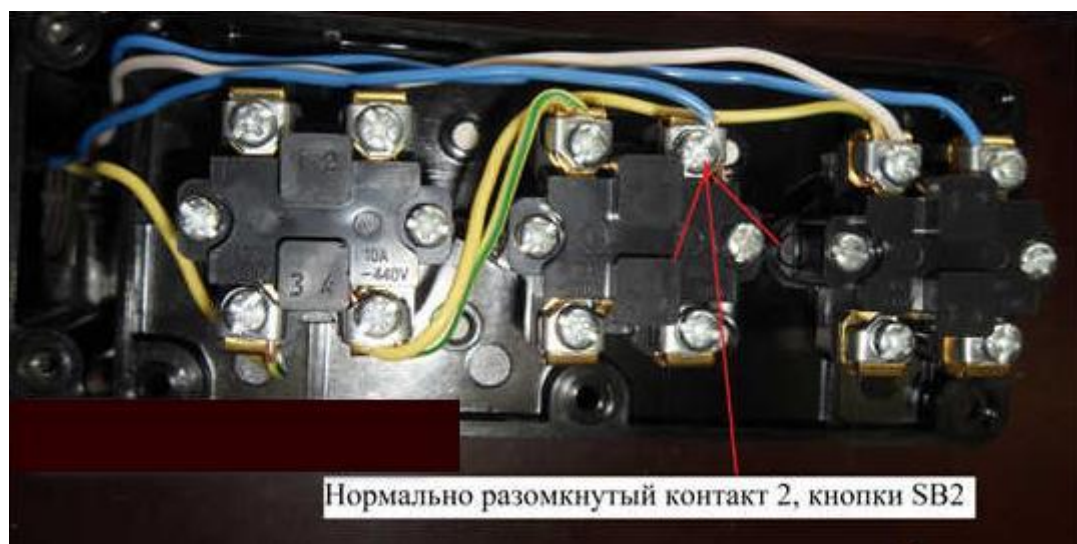
Рисунок 64 – Сборка соединения пусковой кнопки обратного вращения двигателя с блок-контактом магнитного пускателя на стенде
