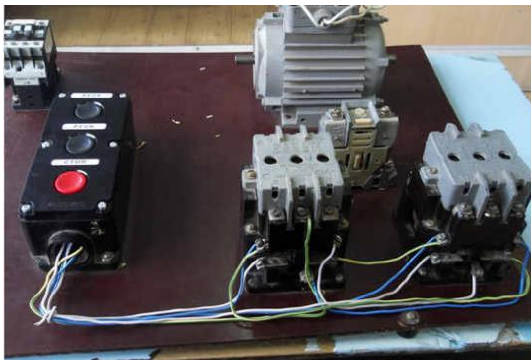
Рисунок 76 – Сборка кнопочного поста завершена
