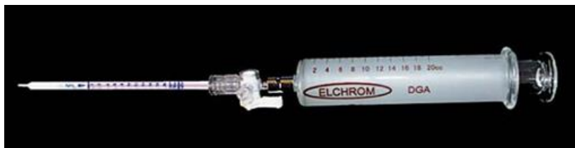
Рисунок 8.2 - Пробоотборное устройство с индикаторной трубкой для оценки газа на горючесть
