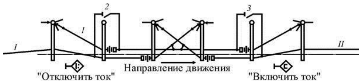
Рис.6 Нейтральная вставка: 1 – дополнительная контактная подвеска; 2,3 – секционные разъединители; 4,5 – предупредительные сигналы; I,II – контактные подвески сопрягаемых анкерных участков.
