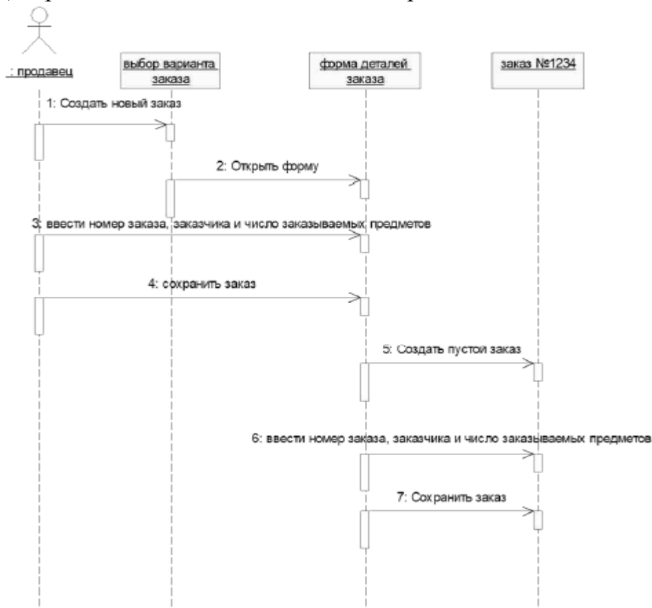
Рис. 2. Диаграмма последовательности без управляющих элементов.
