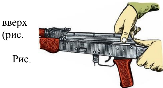
8. Отделение крышки ствольной коробки
