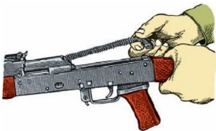
Рис. 9. Отделение возвратного механизма
