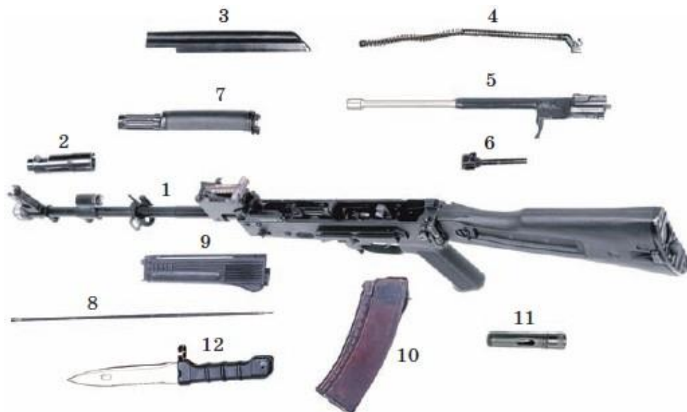
Рис. 2. Основные части и механизмы автомата АК-74: 1 — ствол со ствольной коробкой, прицельным приспособлением и прикладом; 2 — дульный тормоз-компенсатор; 3 — крышка ствольной коробки; 4 — возвратный механизм; 5 — затворная рама с газовым поршнем; 6 — затвор; 7 — газовая трубка со ствольной накладкой; 8 — шомпол; 9 — цевьё; 10 — магазин; 11 — пенал принадлежности; 12 — штык-нож
