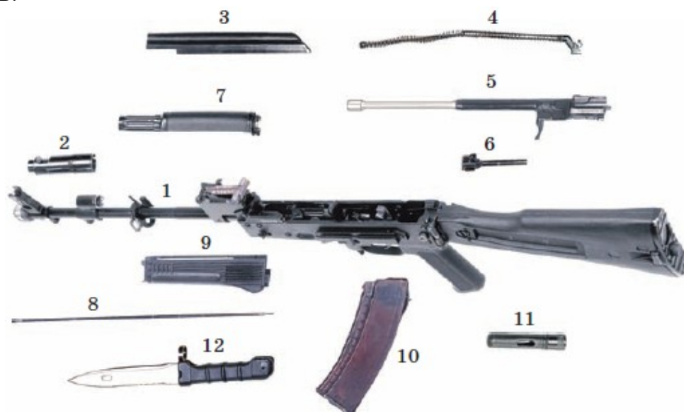
Рис. 2. Основные части и механизмы автомата АК-74: 1 — ствол со ствольной коробкой, прицельным приспособлением и прикладом; 2 — дульный тормоз-компенсатор; 3 — крышка ствольной коробки; 4 — возвратный
