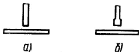
Рисунок 27 – Варианты соединения стенки балки с полкой
