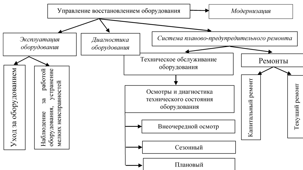
Рис. 5. Модель управления восстановлением оборудования предприятий нефтегазового комплекса
