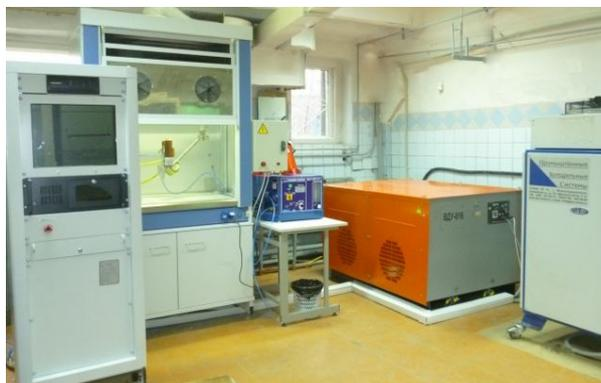
Рис. 1. Напылительный электроплазменный автоматизированный комплекс камерного типа
