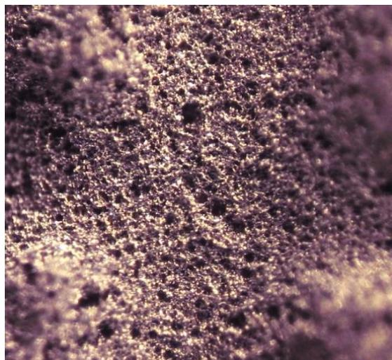
Рис. 2. Микрофотография поверхности стали с Ni-покрытием
