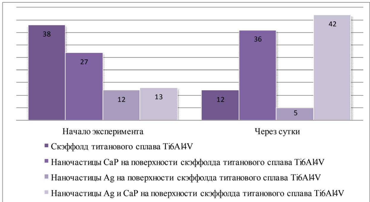
Рис. 3. Количество бактерий на металлических образцах титанового сплава Ti6Al4V на начало эксперимента и через сутки
