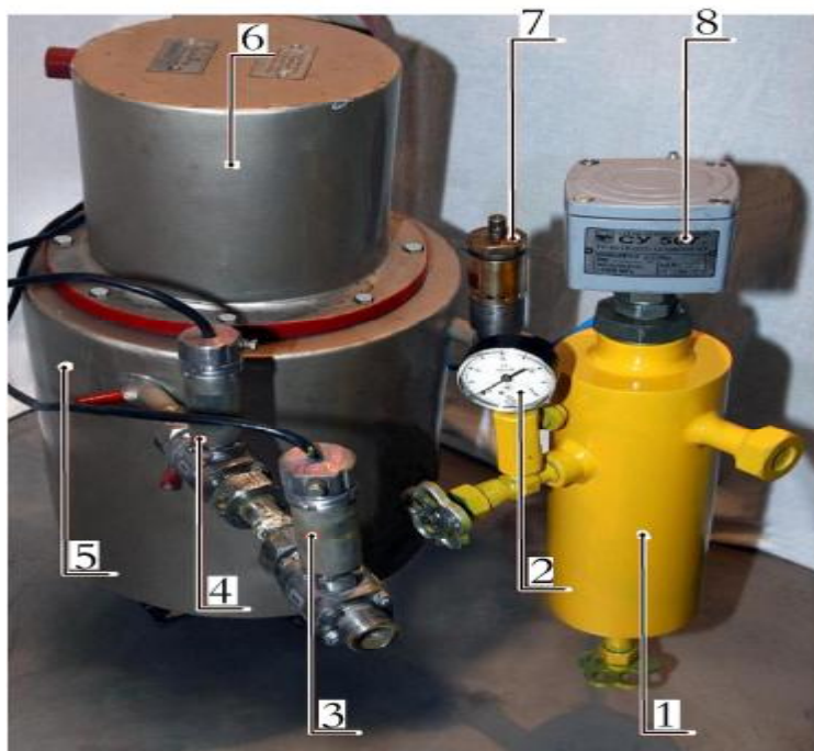
Рис. 12. Общий вид серийного образца электрического ПТИ с ПТС из алюминия 1 – конденсатосборник; 2 – узел замера давления СУГ; 3 – электромагнитный клапан системы контроля минимальной температуры паровой фазы СУГ; 4 – электромагнитный клапан системы контроля максимального уровня жидкой фазы СУГ; 5 – цилиндрический массив из алюминия с замоноличенными в него ИТЗ и группой ТЭН; 6 – взрывонепроницаемая оболочка; 7 – предохранительный сбросной клапан; 8 – сигнализатор предельного уровня жидкой фазы СУ -507
