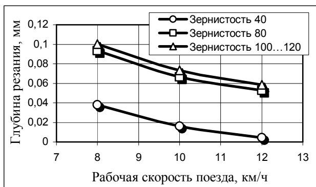
Рис. 20. Влияние зернистости абразивного инструмента на глубину резания
